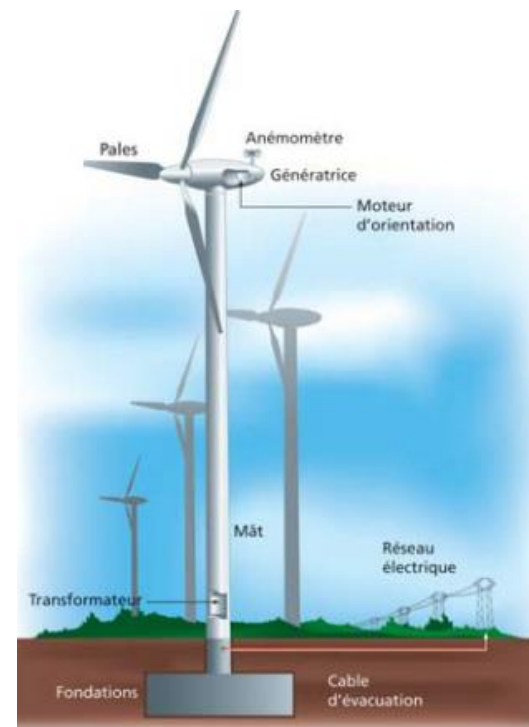
Figure 22 : Représentation schématique d'une éolienne (Source : EDF)
